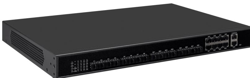
Управляемый коммутатор GEAPON, 8 портов комбо 1000BASE-T/SFP, 8 портов GEAPON, консольный порт, порт управления MGMT, встроенный БП разъем питания на задней панели, 100-240В AC, размеры ШxГxВ (440x280x44 мм)
