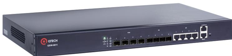
Управляемый коммутатор GE PON, 4 порта комбо 1000BASE-T/SFP, 4 порта GE PON, консольный порт, порт управления MGMT, 2 встроенных БП разъем питания на задней панели, 100-240В AC-AC, размеры ШхГхВ (440x251x44 мм)
