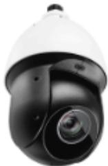
Скоростная купольная поворотная уличная IP-видеокамера 2 Мп 4.8-120 мм/F1.6, трансфокатор 25x оптический зум, дальность ИК подсветки 100 м, IP66, MicroSD карты до до 256 Гб, -40°C~+70°C, PoE 802.3at, внешний БП (поставляется отдельно), питание PoE, 12В DC
