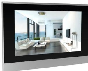
Сенсорная абонентская видеопанель. Экран TFT размер 7", 800x480, яркость 200cd/m, контраст 500:1, 2 порта 10/100Мб, 12В/POE, ОС Linux, пластиковый корпус, 220 x 132 x 27 мм. Поддержка RS486. Wi-Fi Установка на стену
