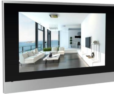
Сенсорная абонентская видеопанель. Экран TFT размер 7", 1024x600, яркость 270cd/m, контраст 800:1, 2 порта 10/100 BASE-T, 8 пар "сухих" контактов для подключения датчиков, одно исполнительное реле. 12В/POE, ОС Android, пластиковый корпус, 200 x 132x27мм. RS485. Wi-Fi. Установка на стену
