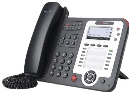
IP телефон, 3 линии SIP, 51 клавиша, 12 программируемых, графический LCD экран 132x64 с подсветкой, 2 порта 10/100/1000BASE-T (LAN/PC), PoE 802.3af, внешний БП (поставляется отдельно), питание PoE, 12В DC
