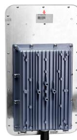
Внешнее абонентское устройство, 2.312-2.4835 и 5.180-5.825 ГГц, 300/900 Мбит/с, 802.11 a/b/g/n/ac, PoE 802.3at, 2x2 MIMO, коэфф. усиления 18 дБи, OFDM = BPSK, QPSK, 16-QAM, 64-QAM, DSSS = DBPSK, DQPSK, CCK, внешний БП (поставляется отдельно), питание PoE, 48В DC
