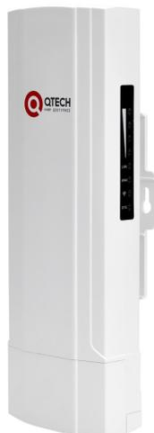
Внешнее абонентское устройство, 2.312-2.4835 ГГц, 300 Мбит/с, 802.11 a/n, PoE 802.3af, 2x2 MIMO, коэфф. усиления 14 дБи, OFDM = BPSK, QPSK, 16-QAM, 64-QAM, DSSS = DBPSK, DQPSK, CCK, внешний БП, питание PoE, 24В DC
