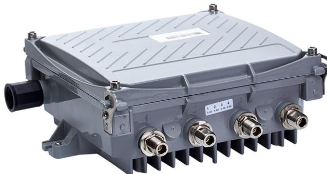
Внешняя точка доступа, 2.412-2.472 и 5.180-5.825 ГГц, 300/900 Мбит/с, 802.11 a/b/g/n/ac, PoE 802.3at, 2x2 MIMO, BPSK, QPSK, 16QAM, 64QAM, питание PoE (инжектор поставляется отдельно), 48В DC
