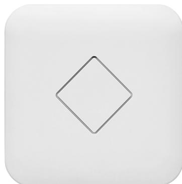
Внутренняя точка доступа, 2.412-2.472 и 5.180-5.825 ГГц, 300/900 Мбит/с, 802.11 a/b/g/n/ac, 1 порт 10/100/1000BASE-T, PoE 802.3at, 2x2 MIMO, коэфф. усиления 5 дБи, BPSK, QPSK, 16QAM, 64QAM, внешний БП (поставляется отдельно), питание PoE, 12В DC
