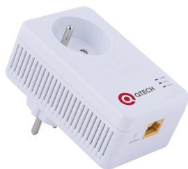
PLC-адаптер, 1 порт 10/100BASE-T (LAN), HomePlug AV/AV2, 128-bit AES, проходная розетка 16А, 100-240В АС
