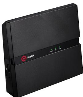
Беспроводной маршрутизатор 2.4/5 ГГц со встроенным коммутатором 4 порта 10/100/1000BASE-T (LAN), 1 порт 10/100/1000BASE-T (WAN), 1 порт USB 2.0, Wi-Fi 802.11 a/b/g/n/ac, внешний БП, 12В DC
