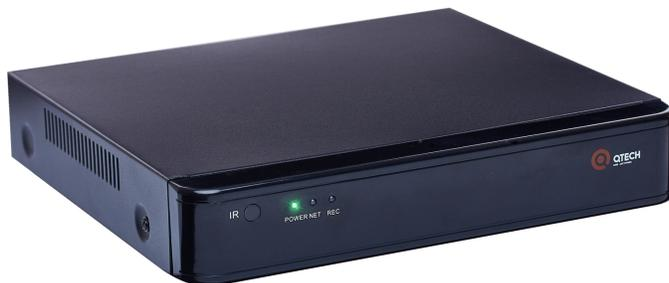
Видеорегистратор, 4 канала записи, 1 слот SATA, емкость HDD до 8 Тб, H.264, 1 порт 10/100BASE-T, VGA, HDMI, 2 порта USB 2.0, внешний БП, 12В DC
