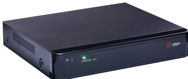
Видеорегистратор, 8 каналов записи, 1 слот SATA, емкость HDD до 8 Тб, H.264, 1 порт 10/100BASE-T, VGA, HDMI, 2 порта USB 2.0, внешний БП, 12В DC
