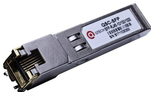
Оптический модуль Соррег SFP, скорость передачи 1.0 Гбит/с, дальность 0,1 км, разъем RJ-45
