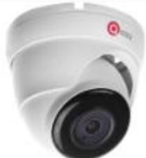
Купольная вандалостойкая IP-видеокамера 5 Мп, фиксированный объектив 2.8 мм/F1.2, дальность ИК подсветки 30 м, IP67, MicroSD карты до 128 Гб, -50°C~+60°C, внешний БП (поставляется отдельно), питание PoE, 12В DC
