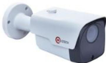
Цилиндрическая уличная IP-видеокамера 5 Мп, вариофокальный объектив 2.8-12 мм, моторизованный зум, дальность ИК подсветки 40 м, IP67, MicroSD карты до 128 Гб, -50°C~+60°C, PoE 802.3af, внешний БП (поставляется отдельно), питание PoE, 12В DC
