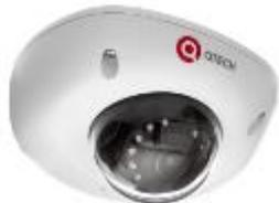
Купольная уличная вандалостойкая IP-видеокамера 4 Мп, фиксированный объектив 2.8 мм, дальность ИК подсветки 20 м, IP66, IK10, MicroSD карты до 128 Гб, -40°C~+60°C, PoE 802.3af, внешний БП (поставляется отдельно), питание PoE, 12В DC
