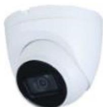
Купольная вандалостойкая IP-видеокамера 2.1 Мп, фиксированный объектив 2.8 мм, дальность ИК подсветки 30 м, IP67, -10°C~+50°C, PoE 802.3af, внешний БП (поставляется отдельно), питание PoE, 12V DC
