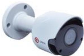
Цилиндрическая уличная IP-видеокамера 5 Мп, фиксированный объектив 2.8 мм/F2.0, дальность ИК подсветки 20м (скрытая подсветка объекта, диапазон длины волны: 940nm) м, IP67, MicroSD карты до 256 Гб, -40°C~+60°C, PoE 802.3af, внешний БП (поставляется отдельно), питание PoE, 12В DC
