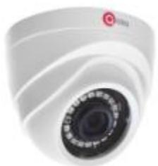
Купольная IP-видеокамера 2.1 Мп, Wi-Fi, фиксированный объектив 2.7 мм/F1.8, дальность ИК подсветки 20 м, IP54, MicroSD (опционально) карты до 128 Гб, -10°C~+60°C, внешний БП (поставляется отдельно), 12В DC
