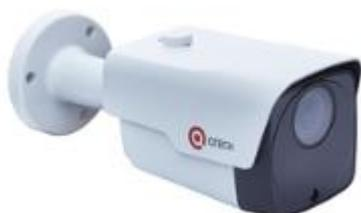
Цилиндрическая уличная IP-видеокамера 2 Мп, вариофокальный объектив 5-50 мм/F1.4, моторизованный зум, дальность ИК подсветки 80 м, IP67, MicroSD карты до 128 Гб, -40°C~+60°C, PoE 802.3af, внешний БП (поставляется отдельно), питание PoE, 12В DC
