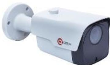
Цилиндрическая уличная IP-видеокамера 8 Мп, вариофокальный объектив 3.3-12 мм/F1.4, моторизованный 4.3x оптический зум, дальность ИК подсветки 40 (до 33° основной / до 100° рассеянный, длина волны: 850nm) м, IP67, MicroSD карты до 128 Гб, -40°C~+60°C, PoE 802.3af, внешний БП (поставляется отдельно), питание PoE, 12В DC
