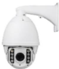
Скоростная купольная поворотная уличная IP-видеокамера 2 Мп, вариофокальный объектив 4.7-108.1 мм, моторизованный 23x оптический зум, дальность ИК подсветки 150 м, IP67, MicroSD, -60°C~+70°C, PoE 802.3af, внешний БП, питание PoE, 24В DC
