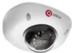
Купольная уличная вандалостойкая IP-видеокамера 2.1 Мп, фиксированный объектив 2.8 мм/F1.2, дальность ИК подсветки 20 м, IP67, MicroSD карты до 128 Гб, -50°C~+60°C, PoE 802.3af/at, внешний БП (поставляется отдельно), питание PoE, 12В DC
