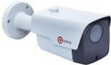
Цилиндрическая уличная IP-видеокамера 5 Мп, вариофокальный объектив 2.8-12 мм, моторизованный 4.3x оптический зум, дальность ИК подсветки 40 (до 33° основной / до 100° рассеянный, длина волны: 850nm) м, IP67, MicroSD карты до 128 Гб, -40°C~+60°C, PoE 802.3af, внешний БП (поставляется отдельно), питание PoE, 12В DC
