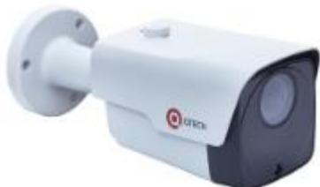
Цилиндрическая уличная IP-видеокамера 3 Мп, вариофокальный объектив 2.8-12 мм, моторизованный зум, дальность ИК подсветки 40 м, IP67, MicroSD карты до 128 Гб, -40°C~+60°C, PoE 802.3af, внешний БП (поставляется отдельно), питание PoE, 12В DC
