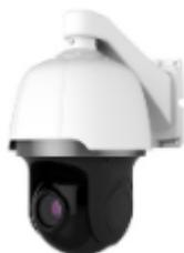
Скоростная купольная поворотная уличная IP-видеокамера 2 Мп, вариофокальный объектив 6-228 мм, моторизованный 38x оптический зум, дальность ИК подсветки 150 м, IP66, -40°C~+70°C, внешний БП, 24В DC
