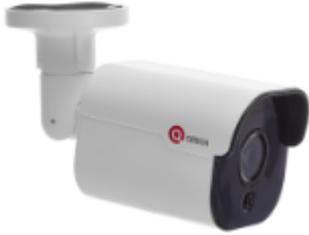
Цилиндрическая уличная IP-видеокамера 2 Мп, фиксированный объектив 2.7 мм, дальность ИК подсветки 20 м, IP67, -40°C~+60°C, PoE 802.3af, внешний БП (поставляется отдельно), питание PoE, 12В DC
