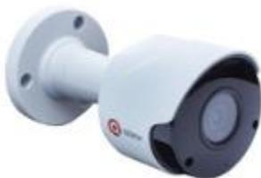
Цилиндрическая уличная IP-видеокамера 5 Мп, фиксированный объектив 3.6 мм/F2.0, дальность ИК подсветки 50 м, IP67, -40°C~+60°C, PoE 802.3af, внешний БП (поставляется отдельно), питание PoE, 12В DC
