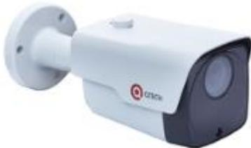
Цилиндрическая уличная IP-видеокамера 5 Мп, вариофокальный объектив 2.8-12 мм/F1.4, моторизованный зум, дальность ИК подсветки 60 м, IP67, MicroSD карты до до 128 Гб, -40°C~+60°C, PoE 802.3af, внешний БП (поставляется отдельно), питание PoE, 12В DC
