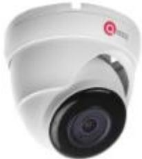
Купольная уличная IP-видеокамера 2 Мп, фиксированный объектив 2.4 мм/F1.2, дальность ИК подсветки 50 м, IP67, MicroSD карты до 256 Гб, -50°C~+65°C, PoE 802.3af, внешний БП (поставляется отдельно), питание PoE, 12В DC
