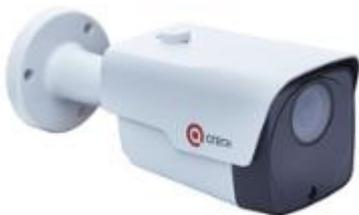
Цилиндрическая уличная IP-видеокамера 2.1 Мп, вариофокальный объектив 2.7-12 мм/F1.2, моторизованный зум, дальность ИК подсветки 60 м, IP67, MicroSD карты до 128 Гб, -50°C~+60°C, PoE 802.3af, внешний БП (поставляется отдельно), питание PoE, 12В DC
