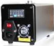
Черное тело, поверхность источника излучения 70×70мм, точность температуры ±0.2, коэффициент излучения 0.97, питание 220В, размеры ШхГхВ (110×120×180 мм)
