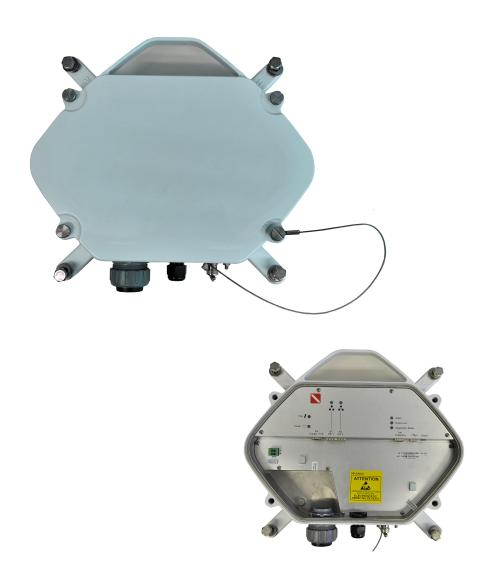
Радиомост 71-76 ГГц и 81-86 ГГц, скорость передачи 1.0 Гбит/с, диаметр антенны 0.3 или 0.6 м, 1 порт 10/100BASE-Т, тип модуляции BPSK/QPSK, внешний БП (поставляется отдельно), питание PoE, 48B DC
