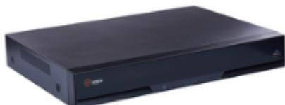
Сетевой видеореги­стратор, 4 канала за­писи, 1 слот SATA, ем­кость HDD до 10 Тб, H.265+/H.265/H.264+/H.264, 1 порт 10/100BASE-T, VGA, HDMI, 2 порта USB 2.0, внешний БП, 12В DC
