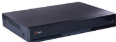
Сетевой видеореги­стратор, 4 канала за­писи, 1 слот SATA, ем­кость HDD до 8 Тб, H.264, 1 порт 10/100BASE-T, VGA, HDMI, 2 порта USB 2.0, внешний БП, 12В DC
